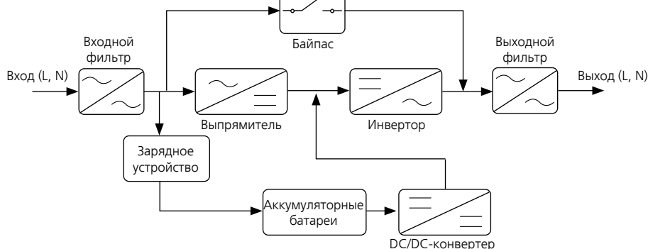
Рисунок 6. Структурная схема принципа работы ИБП
